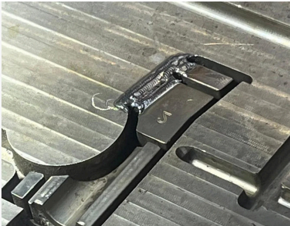
AUFTRAGSCHWEISSUNG, TIEFE FORMTASCHE · 450-W-FASER BUILD-UP WELD, DEEP MOLD POCKET · 450 W FIBER
