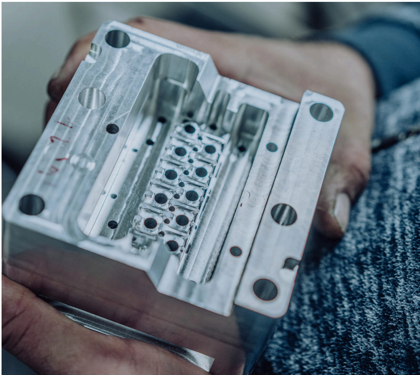
FORMEINSATZ, AUFGESCHWEISST UND NEU GEFRÄST MOLD INSERT, BUILD-UP WELDED AND RE-MACHINED
