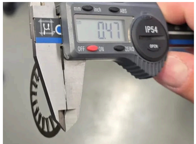
0,47 MM · EIN TEIL, LASERGESCHWEISST AUS ZWEI SCHEIBEN 0.47 MM · ONE PART, LASER-WELDED FROM TWO DISCS
