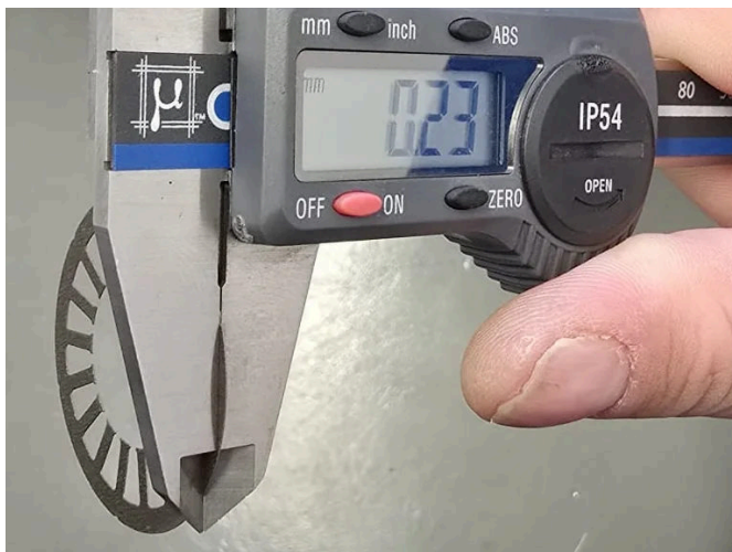
0,23 MM · EINZELNE ZAHNSCHEIBE, VOR DEM SCHWEISSEN 0.23 MM · SINGLE TOOTHED DISC, BEFORE WELDING
