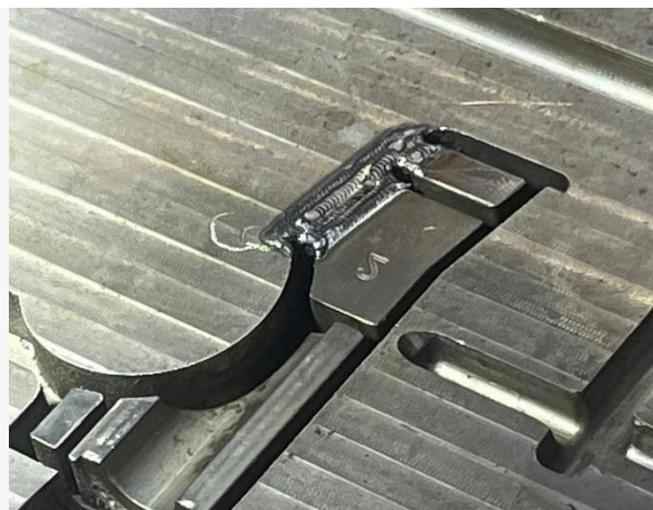
BUILD-UP WELD, DEEP MOLD POCKET · 450 W FIBER AUFTRAGSCHWEISSUNG, TIEFE FORMTASCHE · 450-W-FASER
