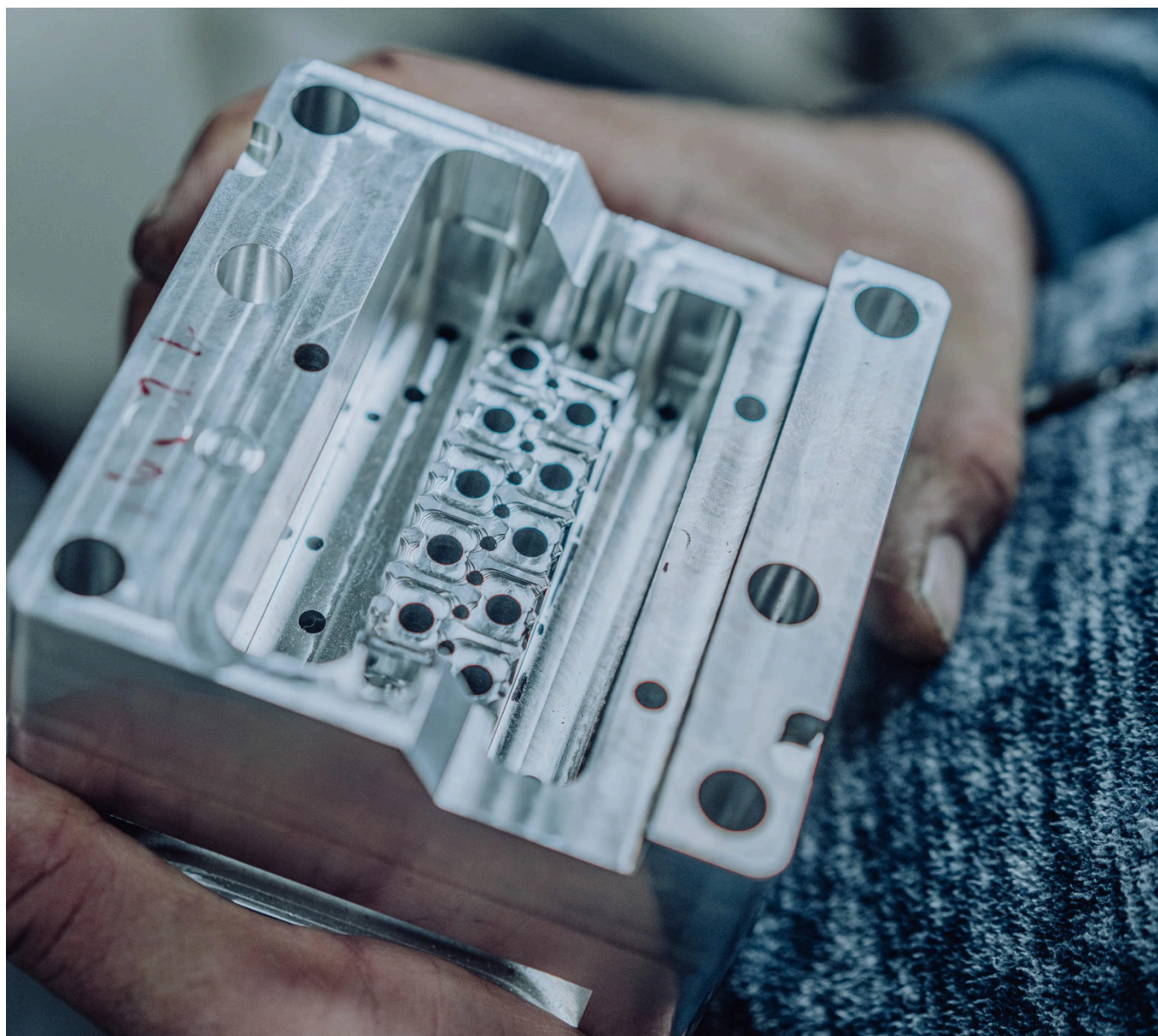
MOLD INSERT, BUILD-UP WELDED AND RE-MACHINED FORMEINSATZ, AUFGESCHWEISST UND NEU GEFRÄST
