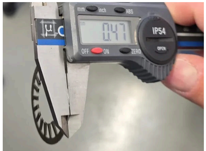
0.47 MM · ONE PART, LASER-WELDED FROM TWO DISCS 0,47 MM · EIN TEIL, LASERGESCHWEISST AUS ZWEI SCHEIBEN
