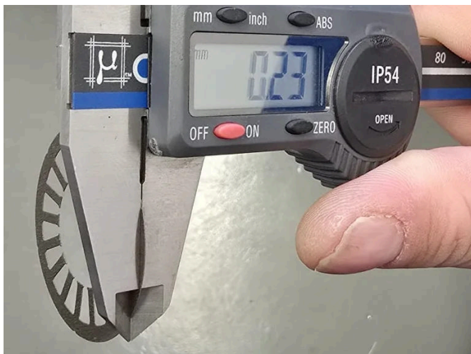
0.23 MM · SINGLE TOOTHED DISC, BEFORE WELDING 0,23 MM · EINZELNE ZAHNSCHEIBE, VOR DEM SCHWEISSEN
