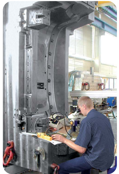
Bearbeitung einer 20t Spritzgußform für die Stoßstangen Produktion.
